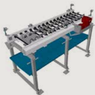
Rollenförderer mit außenliegender Friktion
